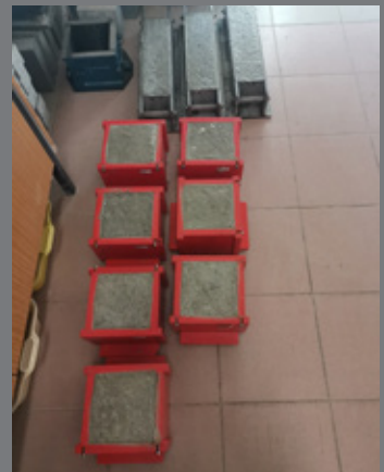
Uzorkovanje svježeg betona
