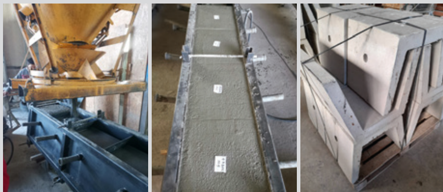
HŽ kanalice TIP II izrađene od projektiranog betona za početno ispitivanje tipa BL-II-8H BP u pogonu tvornice Beton-Lučko d.o.o.
