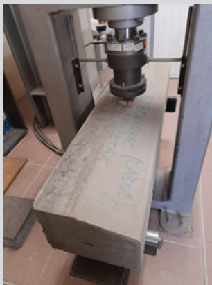
Ispitivanje čvrstoće na savijanje na uzorcima cestovnih rubnjaka u proizvodnom pogonu Beton-Lučko RBG d.o.o.: a) provedenje ispitivanja; b) slom uzorka rubnjaka
