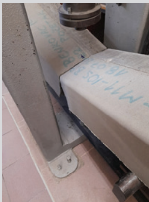
Ispitivanje čvrstoće na savijanje na uzorcima cestovnih rubnjaka u proizvodnom pogonu Beton-Lučko RBG d.o.o.: a) provedenje ispitivanja; b) slom uzorka rubnjaka
