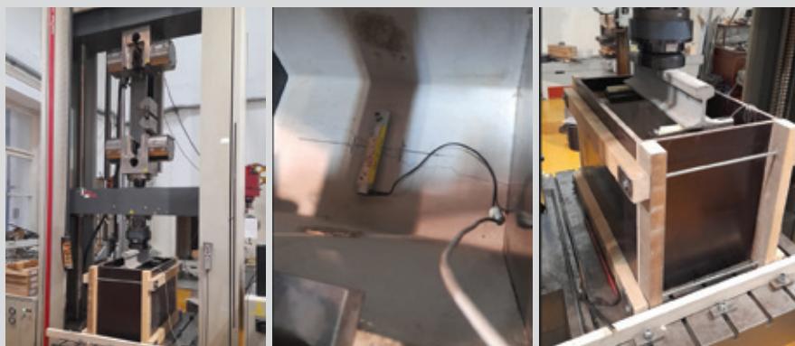
Nanošenje vertikalnog opterećenja (lijevo) i senzor za detekciju i mjerenje širine pukotine (desno)
