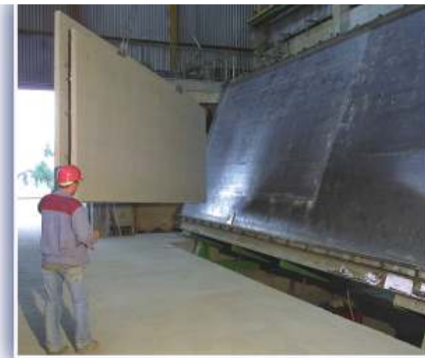
Proizvodnja u modernoj tvornici "BETON LUČKO" daje preciznu i brzu isporuku predgotovljenih elemenata s ugrađenim instalacijama i slijepim okvirima vrata i prozora.
